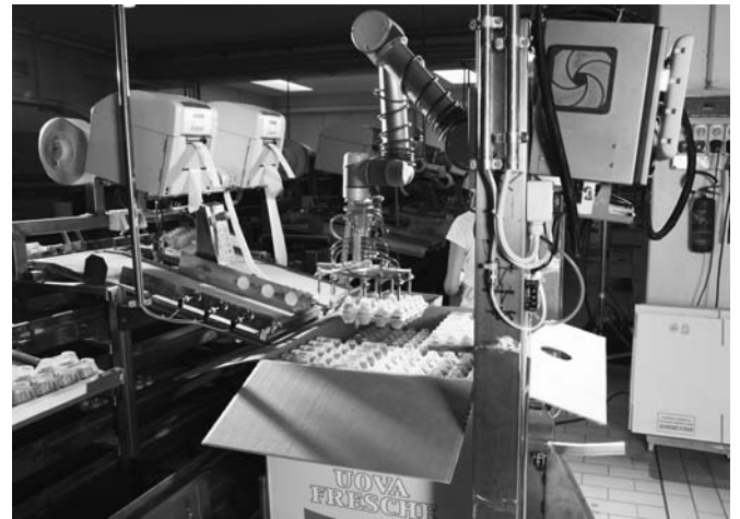
רובוט מבצע משטוח של תבניות ביצים. הרובוט מותקן על עמוד כדי לחסוך בשטח רצפה
